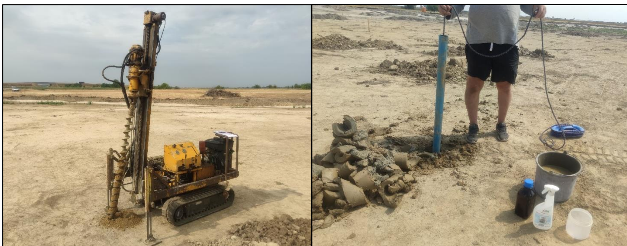
20. ábra: Mintavételi furat kialakítása (balra) és felszín alatti vízminta vétel (jobbra)
